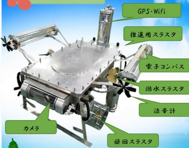
○筐体は箱型で加工性に重きを置き蝶ネジを緩め、蓋を外すことで内部の基盤や制御機器などにアクセスすることが出来るよう設計した。潜行に 2 つのスラスタ、航行に 2 つのスラスタ、旋回に 2 つのスラスタの計 6 つのスラスタで水中航行する。
