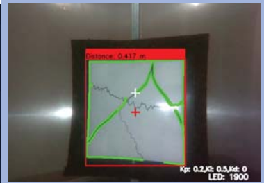
画像処理より傷検知・ターゲット選定
